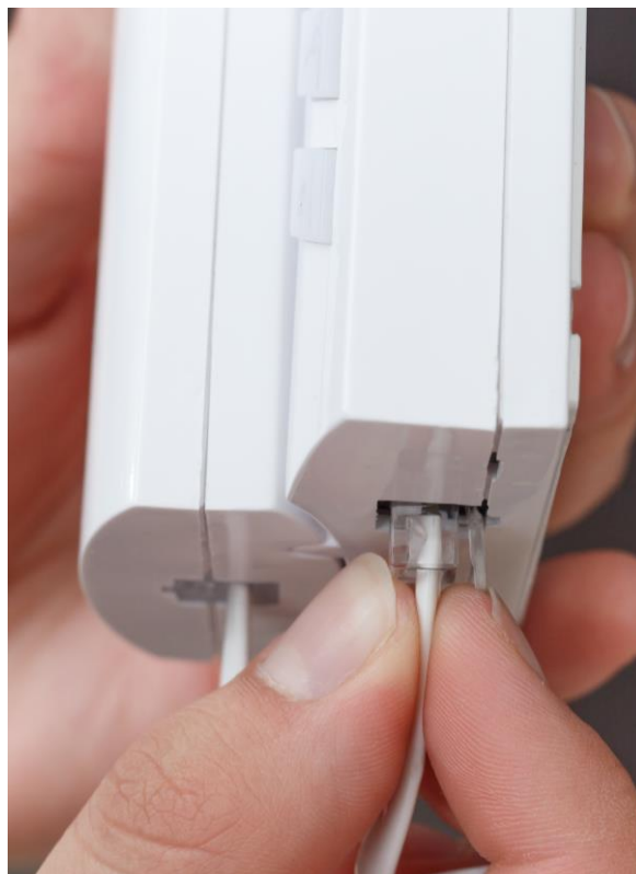
Fot. 1 Wypinanie przewodu słuchawki.
