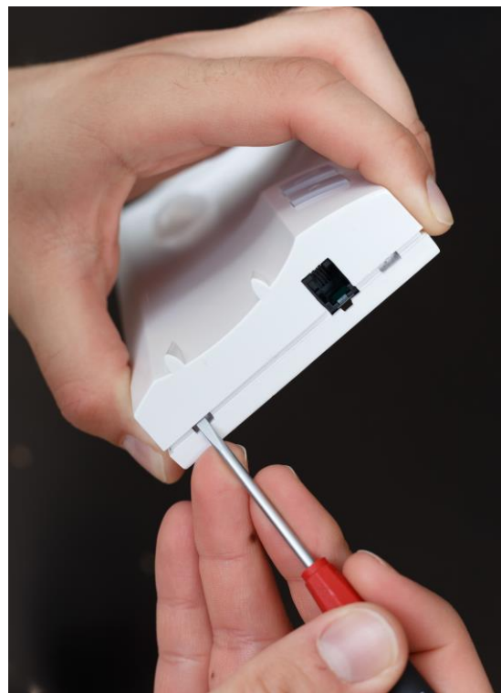
Fot. 2 Zwalnianie dolnych zatrzasków.
