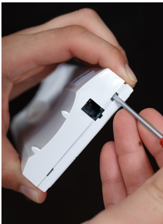
Fot. 2 Zwalnianie dolnych zatrzasków.
