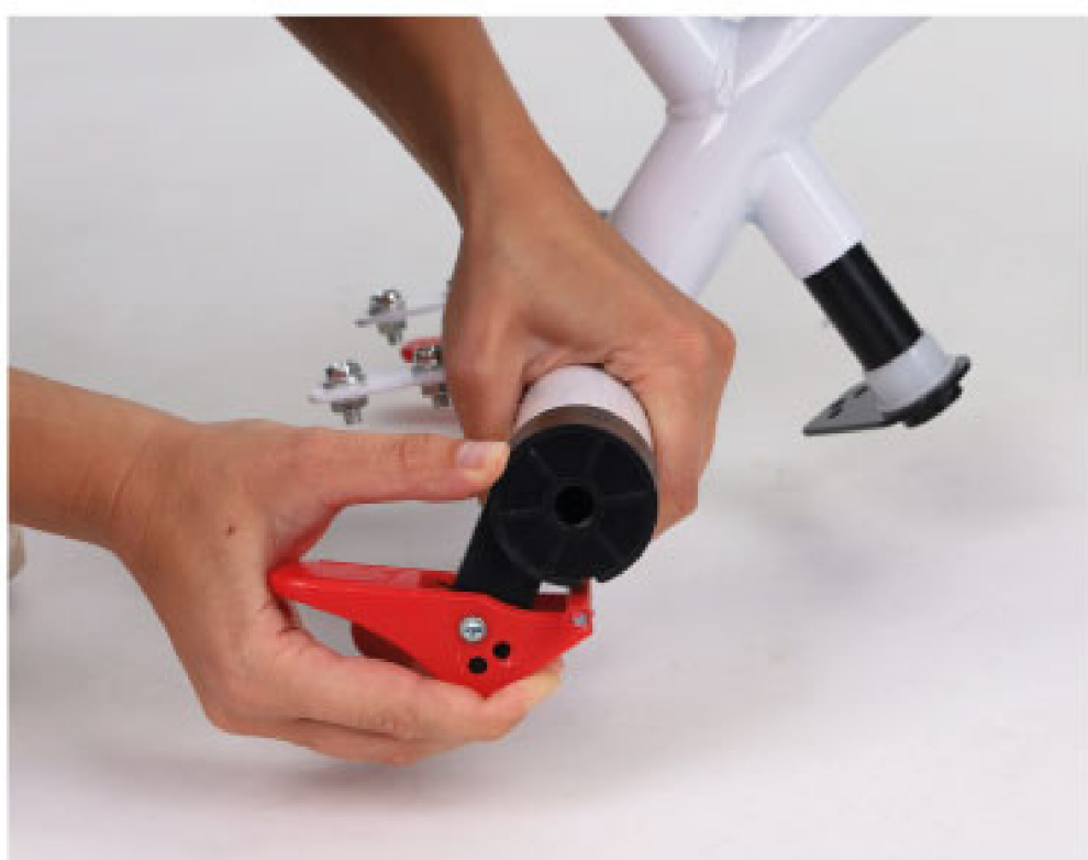
4. Zamontuj hamulce na tylnej osi
