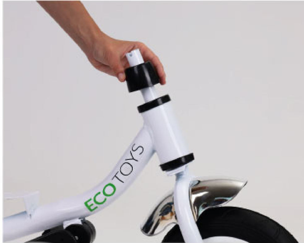
2. Nasadíte kryt na čep řízení.
