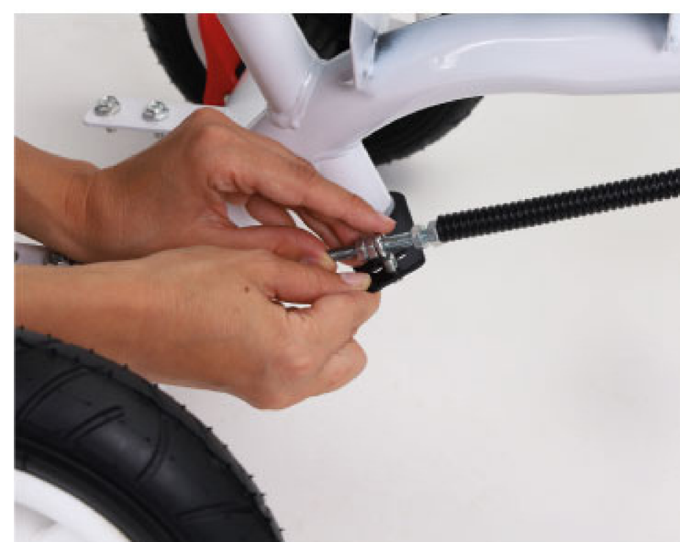
11. Linkę do kierowania zamocuj śrubami
