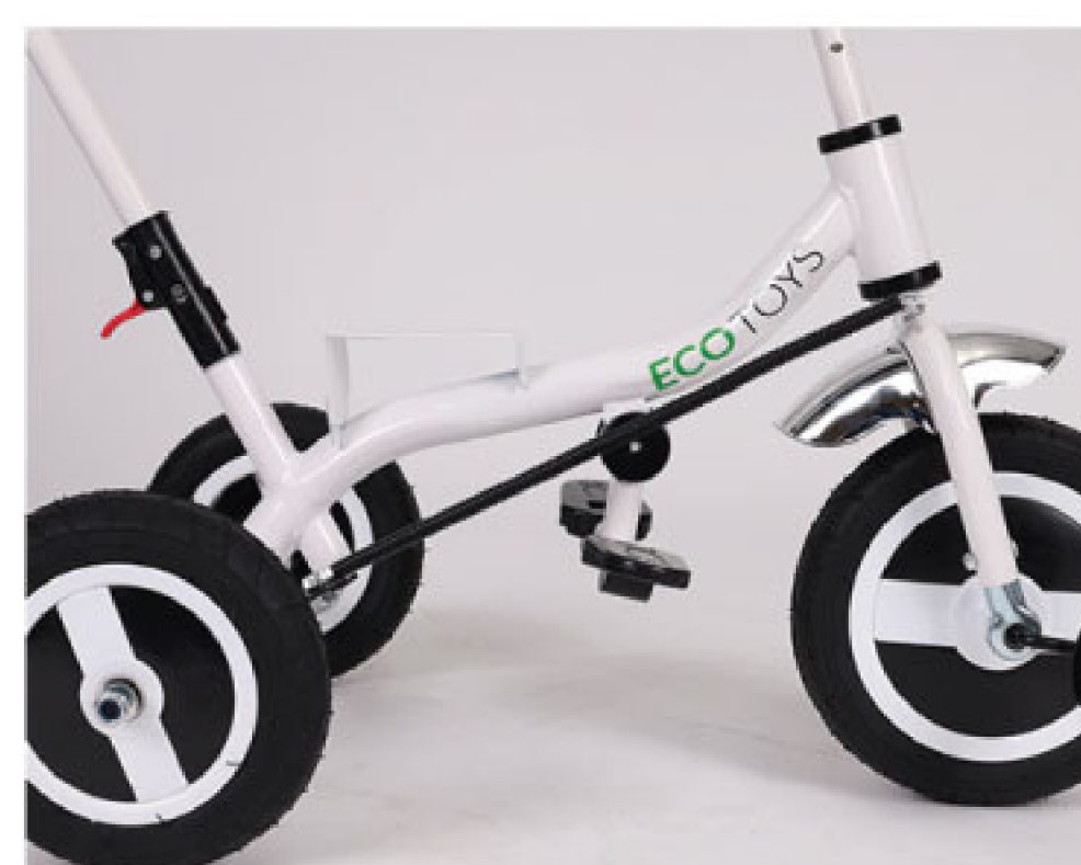
12. Správně namontované ovládací lanko
