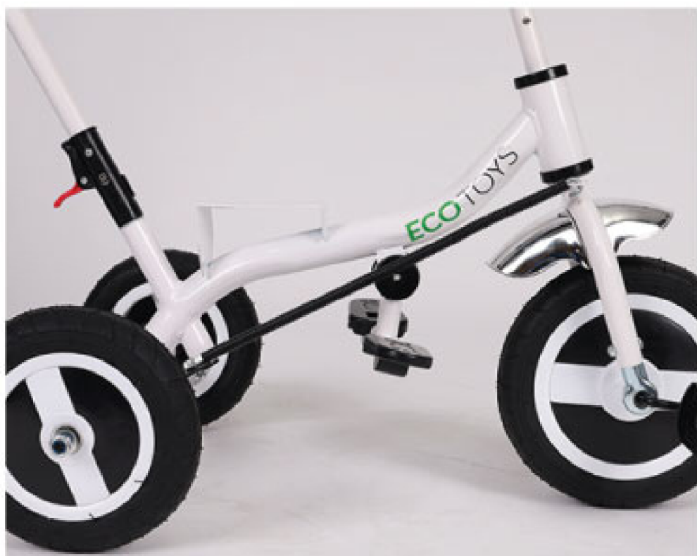
12. Properly installed steering cable 12. Steuerkabel richtig montiert
