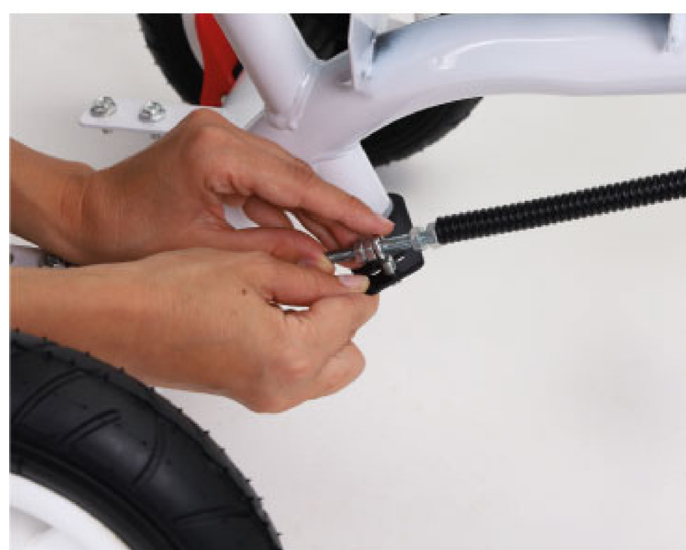
11. Ovládací lanko upevněte šrouby
