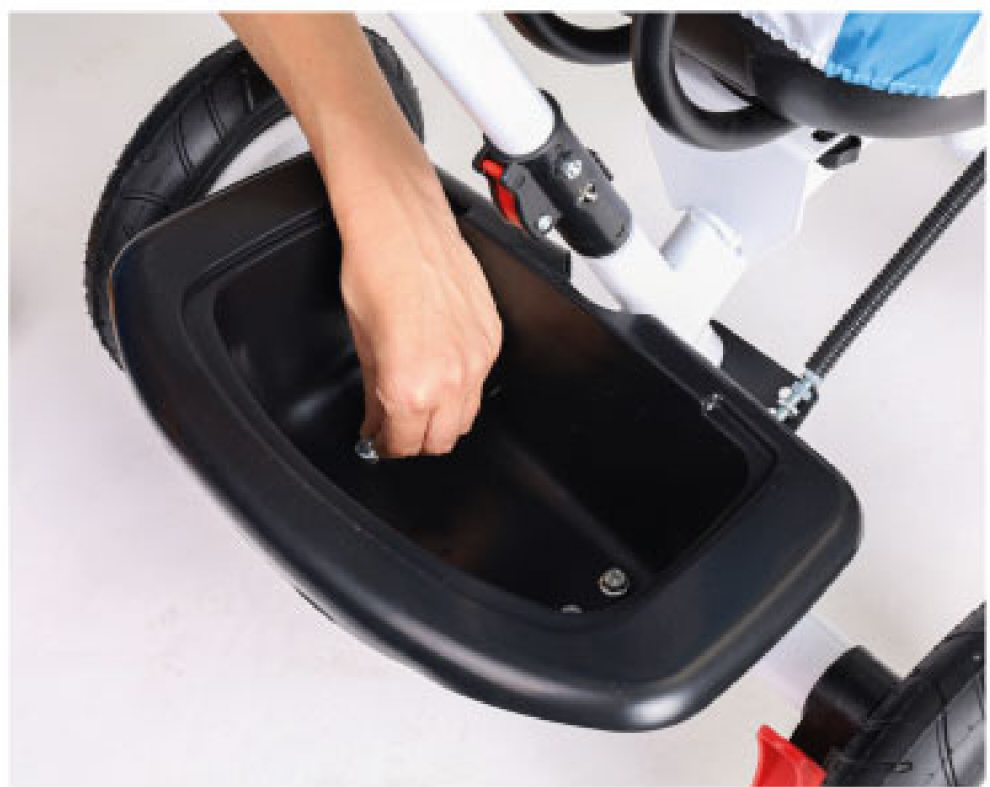
20. Screw on the basket 20. Korb anschrauben
