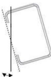
Rys. 2. Skręcanie słupa przy wbijaniu.
