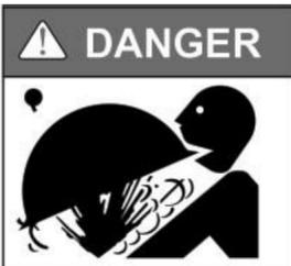
La haute pression du filtre à sable peut provoquer des blessures graves ou des dommages matériels importants en raison de la séparation du réservoir.
