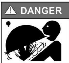
**L'alta pressione del filtro a sabbia può causare gravi lesioni o ingenti danni materiali a causa della separazione del serbatoio.**
