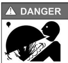
**Högt tryck från sandfiltret kan orsaka allvarliga skador eller större egendomsskador på grund av tankseparering.**
