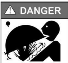
**Hoher Druck aus dem Sandfilter kann zu schweren Verletzungen oder erheblichen Sachschäden aufgrund der Tanktrennung führen.**
