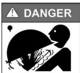
La alta presión del filtro de arena puede provocar lesiones graves o daños importantes a la propiedad debido a la separación del tanque.
