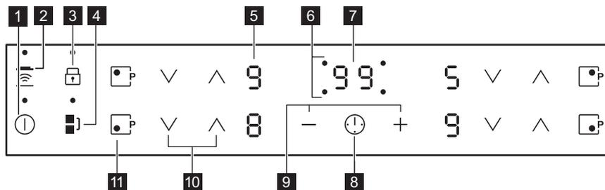
K ovládní spotřebiče používejte sensorová tlačítka. Displeje, ukazatele a zvukové signály signalizují, jaké funkce jsou zapnuté.
