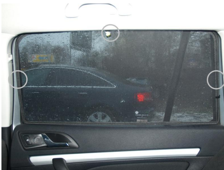
Rys.1 - Miejsca założenia uchwytów na drzwiach
