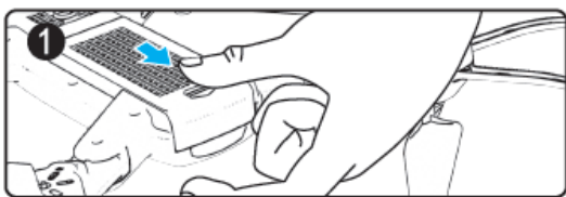
5.1 Odepnij blokadę akumulatora w dronie.
