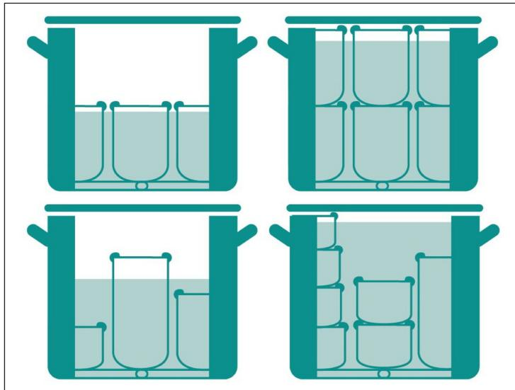
4. Llene la estufa con suficiente agua para cubrir el vaso más alto de 3/4 con agua. No exceda la marca máxima.
