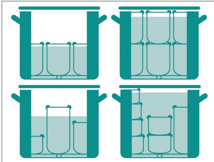
4. Doe net zoveel water in de ketel als nodig is om de hoogste pot  $\frac{3}{4}$  met water te bedekken. Ga daarbij niet over de maximum markering heen.
