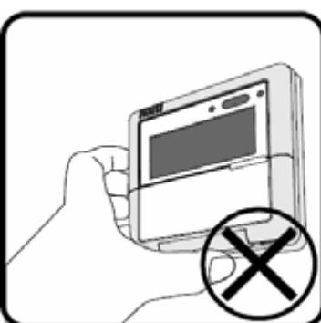
Demontaż od prawej strony
