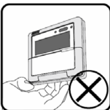
Demontaż od dołu
