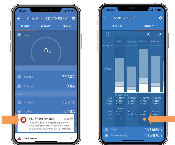
Wskazanie błędu aplikacji VictronConnect nr 33 na ekranie stanu i ekranie historii.
