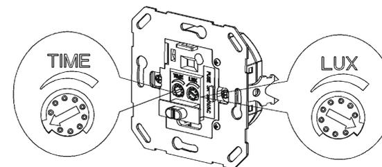
Uwaga: W dzień ustaw LUX na „słońce”, inaczej czujnik nie zadziała. Minimalna odlegość lampy (60W) od czujnika: 60 cm.
