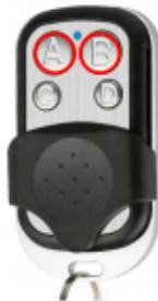
Drücken Sie gleichzeitig die beiden oberen Tasten, bis die LED dreimal schnell blinkt. Lassen Sie dann eine der Tasten los (halten Sie die andere gedrückt) und drücken Sie diese Taste dreimal. Lassen Sie dann beide Tasten los, nachdem die LED schnell blinkt. Das LED-Licht schaltet sich nicht ein, wenn Sie eine Taste drücken. Das bedeutet, dass Sie den Code entfernt haben..
