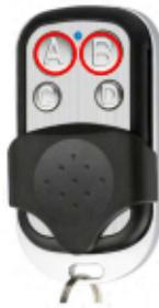
Naciśnij jednocześnie 2 górne przyciski, aż dioda LED zacznie szybko migać 3 razy, następnie zwolnij jeden z przycisków (drugi naciskaj dalej) i naciśnij ten przycisk 3 razy, następnie zwolnij oba przyciski, gdy dioda LED zacznie szybko migać . Dioda LED nie włącza się po naciśnięciu dowolnego przycisku, co oznacza, że kod został usunięty.
