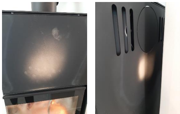
Rysunek 8. Przykłady przebarwień powstałych w wyniku przegrzewania urządzenia.
