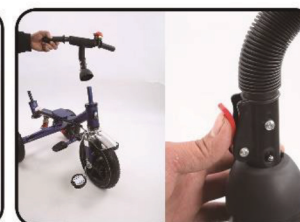
Zainstaluj kierownicę i zablokuj czerwoną rączkę
