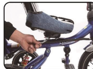
Dokręć nakrętki za pomocą klucza
