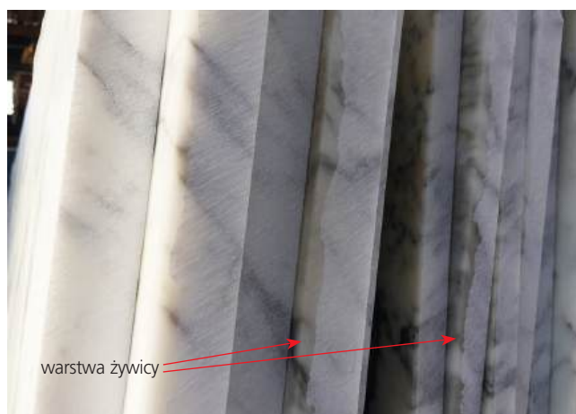
Płyty potraktowane żywicą na powierzchni.
