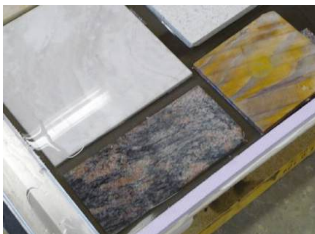
Test: po pewnym czasie na okładzinie kamiennej pojawiają się różnice tonalne.
