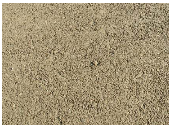
4 Zaprawa drenażowa po związaniu, o otwartej, wodoprzepuszczalnej strukturze.
