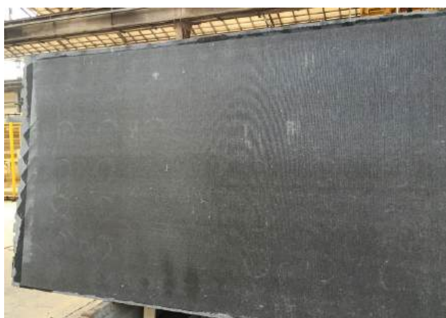
Tylna strona płyty wzmocniona od spodu siatką zatopioną w żywicy reaktywnej.
