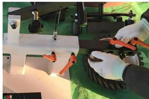
3. Plaats de cirkelslijpmachine in de gereedschapsarm en vergrendel de handgreep
