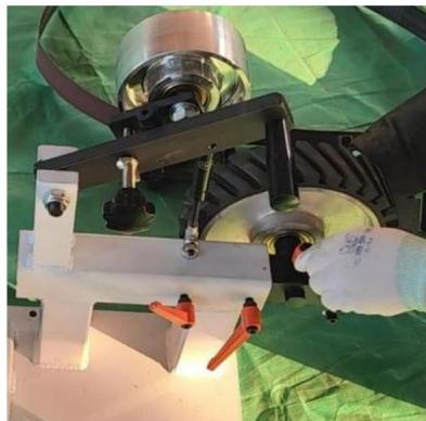
4. Después de colgar la correa de arena, presione hacia abajo el mango negro para sacar el brazo de la herramienta tanto como sea posible, luego bloquee el mango y levante suavemente el mango negro para tensar la cinta de arena.
