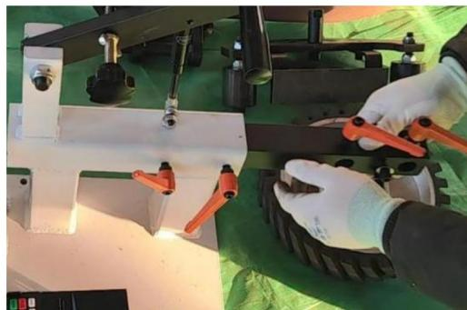
3. Inserte la amoladora circular en el brazo de la herramienta y bloquee el mango.
