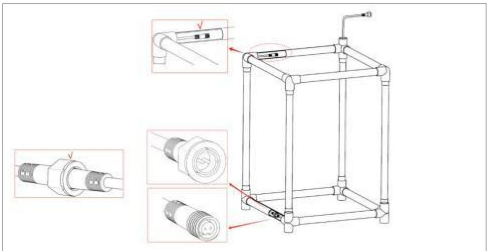
Abbildung 7: Verbinden Sie die Baugruppe in Abbildung 5 und die Baugruppe in Abbildung 6 gemäß der Abbildung miteinander. Der Buchsenanschluss der letzten Lampe muss nicht angeschlossen werden (Hinweis: Zuerst verkabeln! Mit den mit der Verkabelung mitgelieferten Muttern festziehen.)
