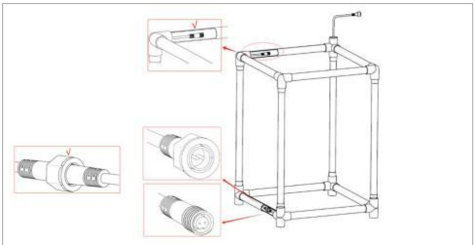
Afbeelding 7: Sluit de assemblage in Afbeelding 5 en de assemblage in Afbeelding 6 aan volgens de afbeelding. De vrouwelijke poort van de laatste lamp hoeft niet te worden aangesloten. (Let op: Eerst de bedrading! Draai vast met de moeren die bij de bedrading zijn geleverd.)
