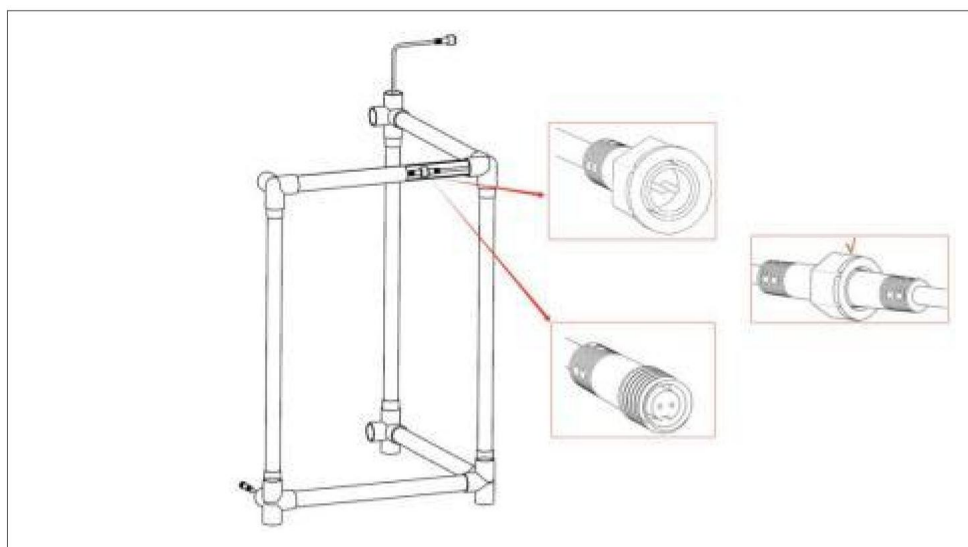
Rysunek 5: Połącz zespół na rysunku 3 i zespół na rysunku 4 zgodnie ze schematem. (Uwaga: Najpierw podłącz przewody! Dokręć nakrętkami dołączonymi do przewodów.)
