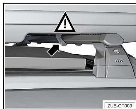
Ana taşıyıcı montajı sırasında açılır tavan ve panoramik tavan üzerindeki boşluk, açma öncesinde kontrol edilmelidir. Yapı parçalarının montaj bracketleriyle monte edilmesi durumunda açılır tavan ve panoramik tavan açılılmamalıdır, çarpışma nedeniyle hasar tehlikesi bulunur!
