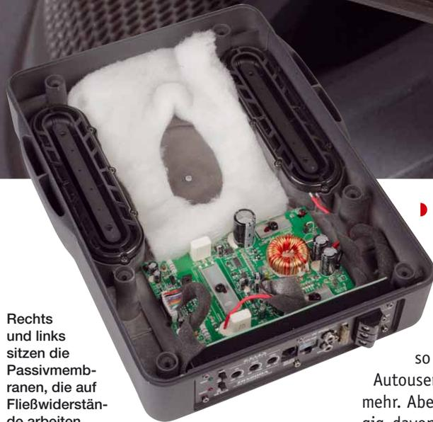
Rechts und links sitzen die Passivmembranen, die auf Fließwiderstände arbeiten
