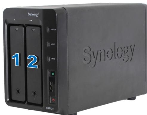
**Anmerkung:** Für die Einrichtung eines RAID-Sets wird empfohlen, Festplatten der gleichen Größe zu installieren, um die Kapazität der Festplatten optimal auszunutzen
