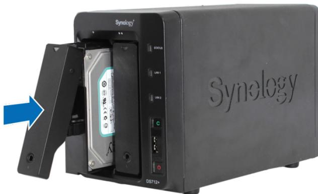
**Wichtig:** Überprüfen Sie, ob das Fach vollständig hineingeschoben ist. Ansonsten läuft die Festplatte möglicherweise nicht ordnungsgemäß.
