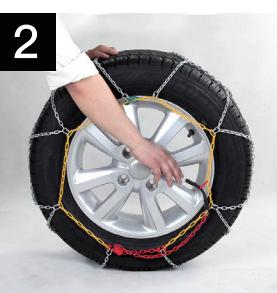
Desprindeți întinzătorul elastic și eliberați lanțul de tensionare mai întâi de la inelul roșu, apoi de la roata roșie de glisare.
