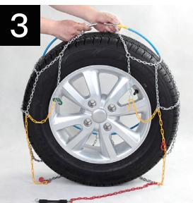
Állítsa meg a járművet úgy, hogy a külső lapos zöld horog a kerék felső részében legyen hátsókerék-hajtású járműveknél (elsőkerék-hajtású járműveknél előrefelé).
