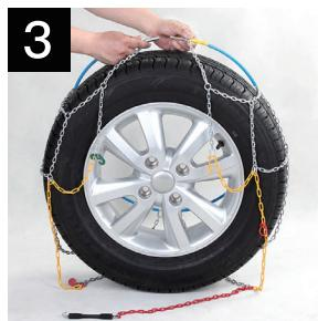
Suelte el cable y deje que la cadena caiga al suelo. Mueva el vehículo lo suficiente para liberar la cadena de debajo del neumático. (En los vehículos con tracción delantera, es mejor hacer girar las ruedas para facilitar la liberación del cable interior).
