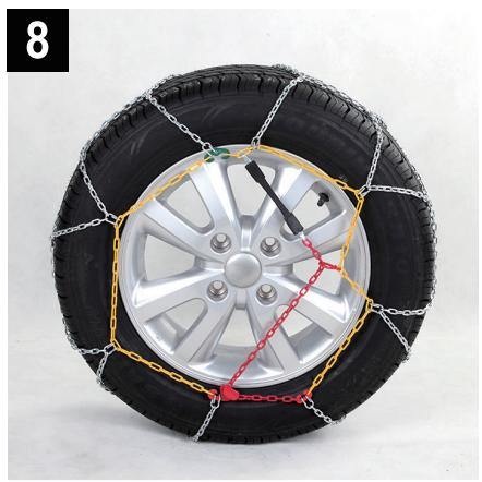
Infilare il tenditore elastico nell'anello metallico rosso e poi, tirandolo il più possibile, fissare il tenditore elastico a una maglia della catena laterale.
