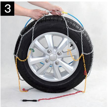
Tire del cable flexible hacia arriba para poder unir los dos extremos de acero.
