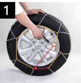
Detenga el vehículo de manera que el gancho verde plano exterior quede en la parte superior de la rueda para vehículos con tracción trasera (hacia el frente para vehículos con tracción delantera).
