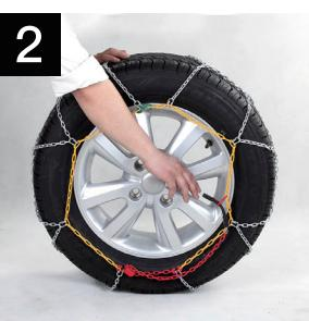
Den Gummispanner aushängen und die Spannkette zuerst vom roten Ring, dann vom roten Schieberad lösen.
