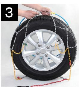
Uvoľnite kábel a nechajte reťaz spadnúť na zem. Pohybujte vozidlom natol'ko, aby ste uvoľnili reťaz spod pneumatiky. (Pri vozidlách s predným náhonom je lepšie pohnúť kolesami, aby sa uľahčilo uvoľnenie vnútorného lanka).
