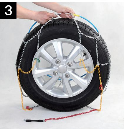
Pociągnij elastyczny kabel do góry, aby można było przymocować dwa stalowe końce razem.
