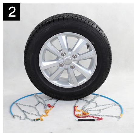
Passez le câble souple (extrémité plastique jaune en premier) derrière le pneu de gauche à droite.
