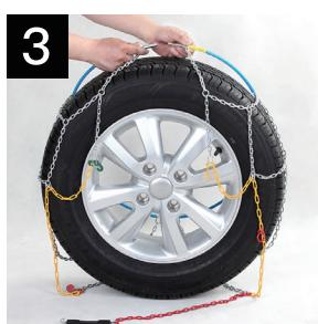
Desfaceți cablul și lăsați lanțul să cadă la pământ. Mișcați vehiculul suficient pentru a elibera lanțul de sub anvelopă. (Pentru vehiculele cu tractiune față, este mai bine să rulați roțile pentru a facilita desprinderea cablului interior).
