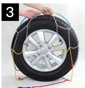
Détachez le câble et laissez la chaîne tomber au sol. Déplacez le véhicule suffisamment pour libérer la chaîne de dessous le pneu. (Pour les véhicules à traction avant, il est préférable de faire tourner les roues pour faciliter le déblocage du câble intérieur).
