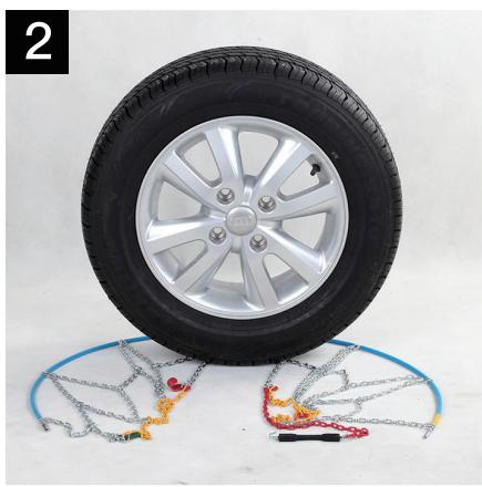
Führen Sie das flexible Kabel (gelbes Kunststoffende zuerst) von links nach rechts hinter dem Reifen hindurch.
