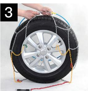
Atskrūvējiet kabeli un laujiet kēdei nokrist zemē. Pārvietojiet transportlīdzekli pietiekami, lai atbrīvotu kēdi no riepas. (Automašīnām ar priekšējo riteņu piedziņu labāk ir braukt ar riteņiem, lai atvieglotu iekšējā troses atsprādzēšanu).
