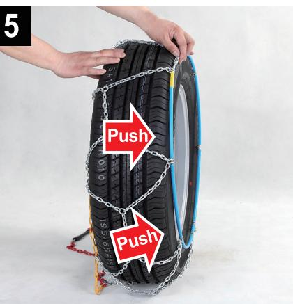
Împingeți cablul flexibil spre interiorul roții și asigurați-vă că nu se află pe banda de rulare a anvelopei.
