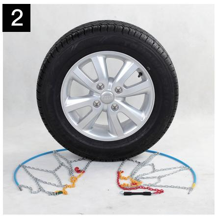
Izvelciet elastīgo kabeli (dzeltenais plastmasas gals vispirms) aiz riepas no kreisās puses uz labo.
