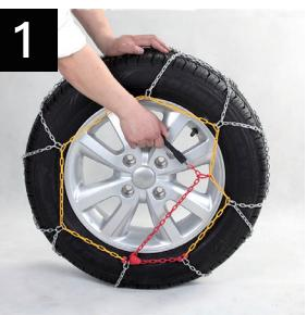
Arrestare il veicolo in modo che il gancio piatto verde esterno si trovi nella parte superiore della ruota per i veicoli a trazione posteriore (verso la parte anteriore per i veicoli a trazione anteriore).
