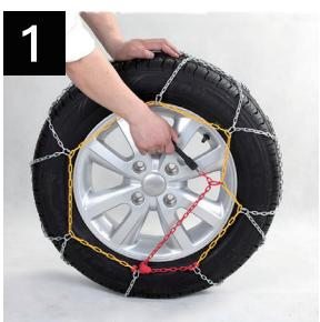
Zatrzymaj pojazd tak, aby zewnętrzny płaski zielony hak znajdował się w górnej części koła w przypadku pojazdów z napędem na tylne koła (w kierunku przodu w przypadku pojazdów z napędem na przednie koła).
