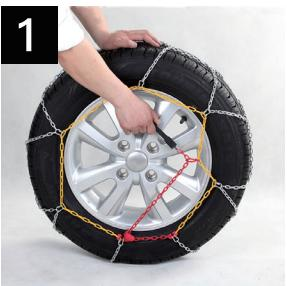
Спрете автомобила така, че външната плоска зелена кука да е в горната част на колелото за превозни средства със задно задвижване (към предната част за превозни средства с предно задвижване).
