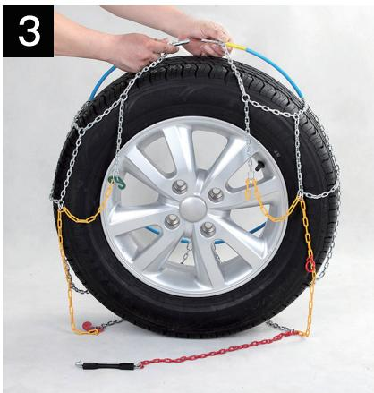
Vytáhněte ohebný kabel směrem nahoru, aby bylo možné oba ocelové konce spojit dohromady.
