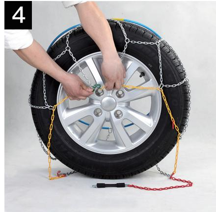
Conectați conectorul verde plat exterior la ultima verigă a capătului lanțului galben.
