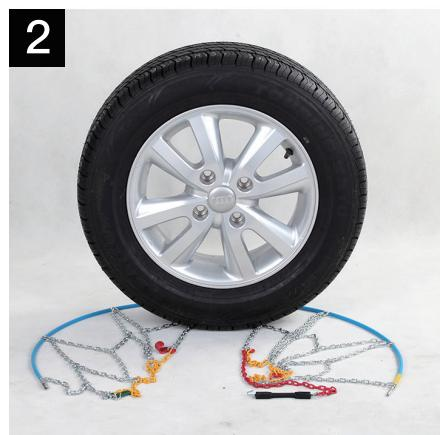
Pase el cable flexible (primero el extremo de plástico amarillo) detrás del neumático de izquierda a derecha.
