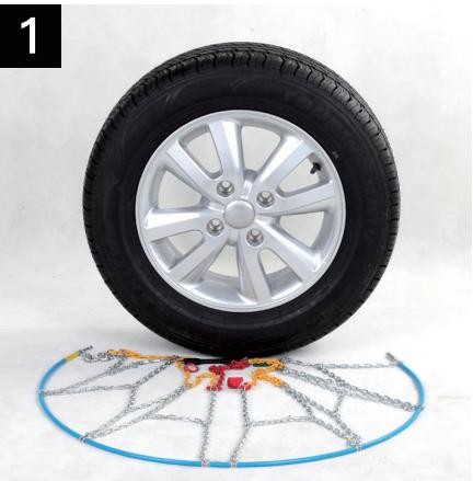
Srotolare la catena a terra, con l'estremità gialla in plastica del cavo rivolta verso sinistra.
