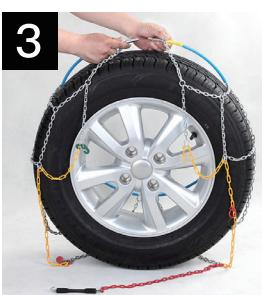
Lösen Sie das Kabel und lassen Sie die Kette auf den Boden fallen. Bewegen Sie das Fahrzeug so weit, dass sich die Kette unter dem Reifen löst. (Bei Fahrzeugen mit Frontantrieb ist es besser, die Räder zu drehen, um das Lösen des inneren Kabels zu erleichtern.)
