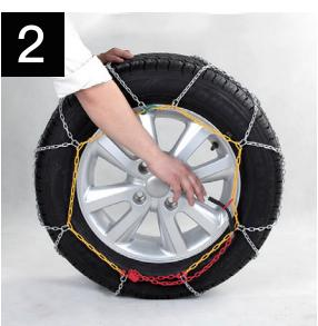
Atvienojiet elastīgo spriegotāju un atlaidiet spriegošanas kēdi vispirms no sarkanā gredzena, pēc tam no sarkanā slīdmehānisma.
