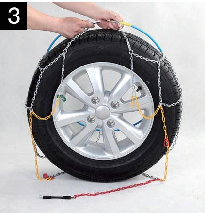
Tirare verso l'alto il cavo flessibile in modo da poter fissare insieme le due estremità in acciaio.
