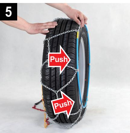
Zatlačte pružný kabel směrem dovnitř kola a ujistěte se, že není na běhounu pneumatiky.
