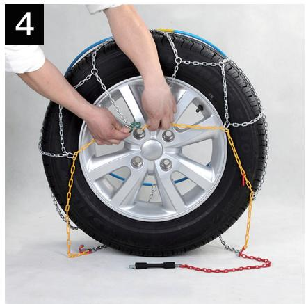
Закачете външния плосък зелен конектор към последната връзка на края на жълтата верига.
