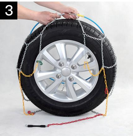
Pavelciet uz augšu elastīgo kabeli, lai abus tērauda galus varētu savienot kopā.
