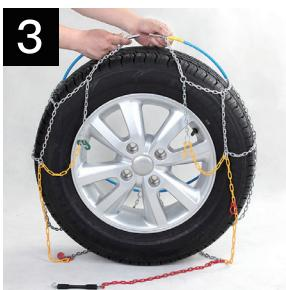
Sganciare il cavo e lasciare che la catena cada a terra. Spostare il veicolo quanto basta per liberare la catena da sotto lo pneumatico. (Per i veicoli a trazione anteriore è meglio far girare le ruote per facilitare lo sgancio del cavo interno).
