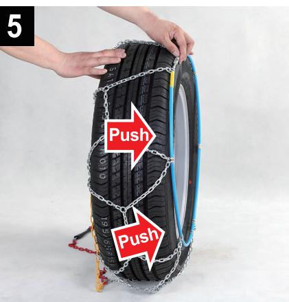
Poussez le câble flexible vers l'intérieur de la roue et assurez-vous qu'il ne repose pas sur la bande de roulement du pneu.
