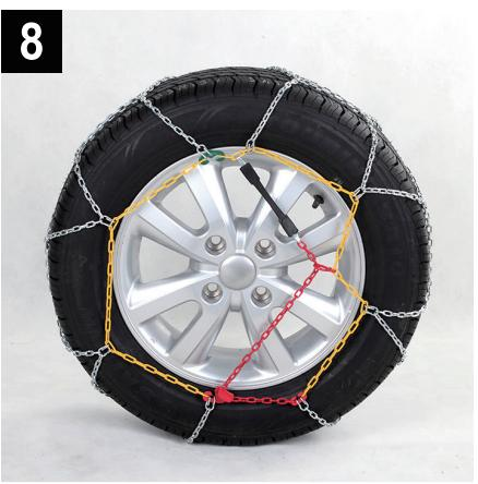
Enrosque el tensor elástico en el anillo metálico rojo y luego, tirando de él lo máximo posible, fije el tensor elástico en un eslabón de la cadena lateral.
