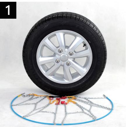
Despliegue la cadena en el suelo, con el extremo de plástico amarillo del cable hacia la izquierda.
