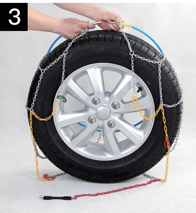
Ziehen Sie das flexible Kabel nach oben, sodass die beiden Stahlenden miteinander verbunden werden können.
