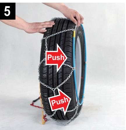
Empuje el cable flexible hacia el interior de la rueda y asegúrese de que no esté sobre la banda de rodadura del neumático.
