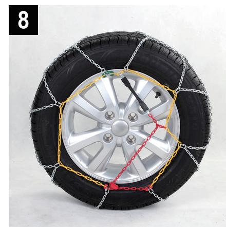
Navlékněte elastický napínák do červeného kovového kroužku a poté zatazením co nejvíce upevněte pružný napínák do článku postranního řetězu.
