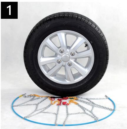
Řetěz rozložte na zemi tak, aby žlutý plastový konec lanka směřoval doleva.
