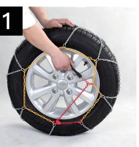
Oriți vehiculul astfel încât cârligul verde plat exterior să fie în partea superioară a roții pentru vehiculele cu tractiune spate (spre față pentru vehiculele cu tractiune față).
