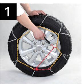
Das Fahrzeug so anhalten, dass sich der äußere flache grüne Haken bei Fahrzeugen mit Hinterradantrieb oben am Rad befindet (bei Fahrzeugen mit Frontantrieb nach vorne).
