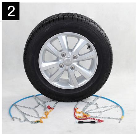
Prevlečte ohybný kábel (najskôr žltý plastový koniec) za pneumatikou zľava doprava.
