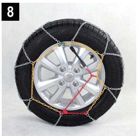
Fädeln Sie den Gummispanner in den roten Metallring ein und befestigen Sie den Gummispanner anschließend durch maximales Ziehen in einem Glied der Seitenkette.
