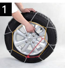
Arrêtez le véhicule de manière à ce que le crochet extérieur plat vert soit en haut de la roue pour les véhicules à traction arrière (vers l'avant pour les véhicules à traction avant).
