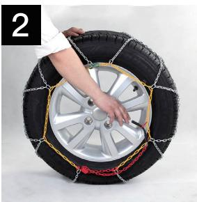
Desenganche el tensor elástico y suelte la cadena tensora primero del anillo rojo y luego del engranaje deslizante rojo.
