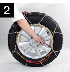
Odpojte elastický napínač a uvoľnite napínaciu reťaz najprv z červeného krúžku, potom z červeného klzného prevodu.
