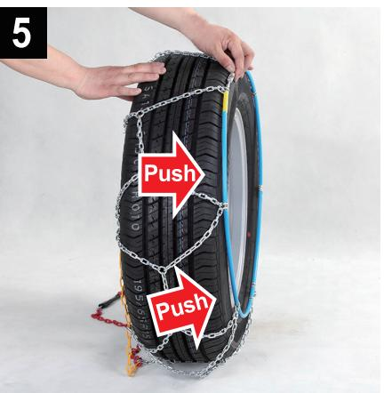
Spingere il cavo flessibile verso l'interno della ruota e assicurarsi che non tocchi il battistrada dello pneumatico.
