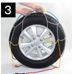
Odepnij linkę i pozwól, aby łańcuch opadł na ziemię. Przesuń pojazd na tyle, aby uwolnić łańcuch spod opony. (W pojazdach z napędem na przednie koła lepiej przesunąć koła, aby ułatwić odpięcie linki wewnętrznej).
