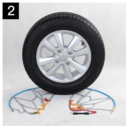
Protáhněte ohebné lanko (nejprve žlutý plastový konec) za pneumatikou zleva doprava.
