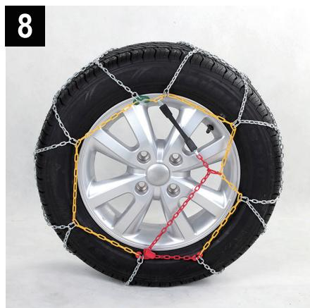
Introduceți întinzătorul elastic în inelul de metal roșu și apoi trăgând de el cât mai mult posibil, fixați întinzătorul elastic într-o verigă a lanțului lateral.
