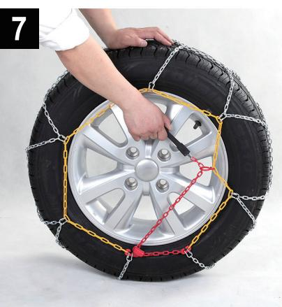
Führen Sie die rote Kette in das rote, selbstsichere Gleitgetriebe ein.
