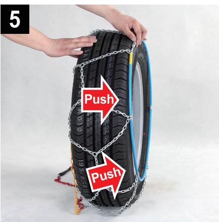
Schieben Sie das flexible Kabel in Richtung Radinneres und achten Sie darauf, dass es nicht auf der Reifenlauffläche aufliegt.
