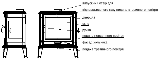
Рис. 1. Схема камінної печі.
