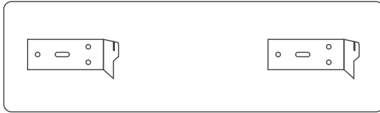
An der Wand montierte Stützen (Abb. 2)
