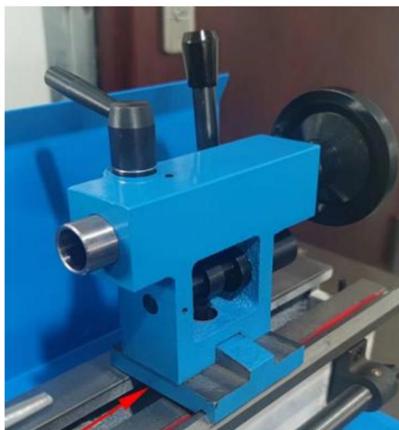
Rys. 3 Regulacja podpórki konika
