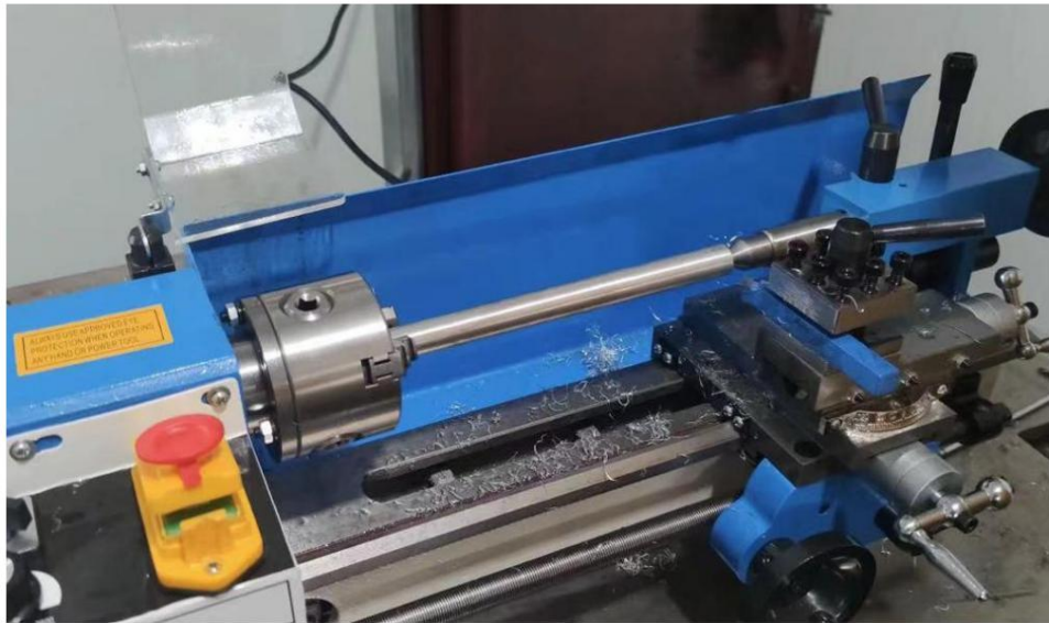
Rys. 6. Mocowanie przedmiotu obrabianego i wiercenie
