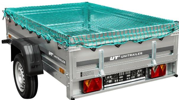
Vorsicht ist geboten, um das Abdecknetz mit den scharfen Kanten der abzudeckenden Ladung nicht zu beschädigen. Das Abdecknetz soll vor Reibung, Abrieb und Beschädigungen durch scharfkantige oder heiße Ladungen geschützt werden.
