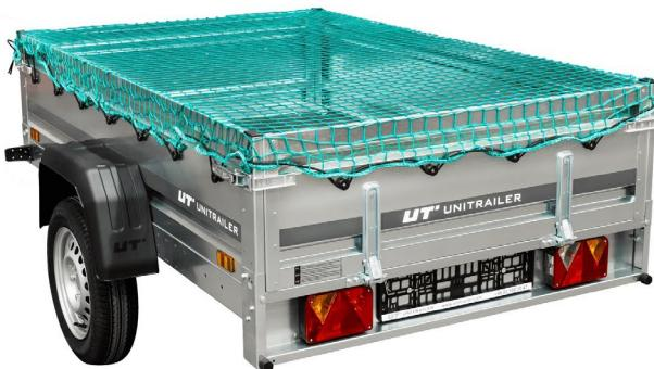
Należy zachować ostrożność, aby nie uszkodzić siatki ostrymi krawędziami okrywanego ładunku. Siatkę należy chronić przed tarciem, ścieraniem i uszkodzeniem ładunkami mającymi ostre krawędzie lub gorącymi.
