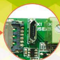
Do programowania port USB micro B
