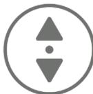
Stisknutím tlačítka oscilace spusťte a zastavíte oscilaci do stran doleva a doprava nebo nahoru a dolů. Jedním stisknutím tlačítka se oscilace zapne a dalším stisknutím tlačítka se pohyb zastaví, čímž lze zafixovat směr ventilátoru.
