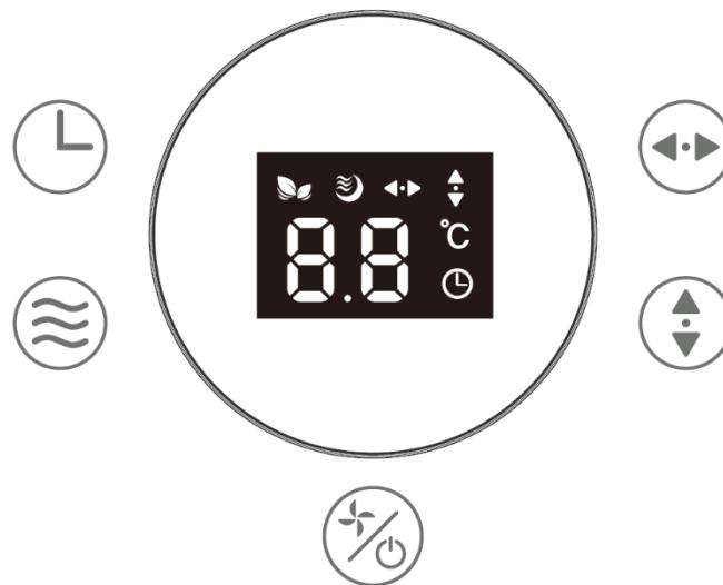
*Upozorňujeme, že všechna tlačítka jsou citlivá na dotyk a při stisknutí pípají. Tlačítka je nutné stisknout rychle, nedržte prst na tlačítku déle než jednu sekundu (s výjimkou zapnutí/vypnutí ventilátoru, viz níže). Ovládací prvky na základně ventilátoru neovládejte nohami.*
