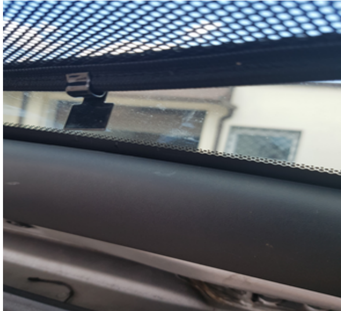
Sposób zamocowania zaczepu w klapie bagażnika
