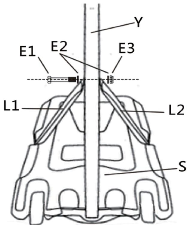
Befestigen Sie ein Ende der Maststrebe (L1) & (L2) am unteren Mast (Y) mit dem Schraubensatz (E1), (E2) & (E3) wie abgebildet.
