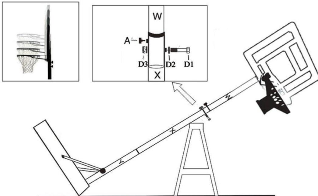
Führen Sie den oberen Mast (W) in den mittleren Mast (X) ein, stellen Sie ihn auf die gewünschte Höhe ein und befestigen Sie ihn dann mit dem Kunststoffknopf (A) und dem Schraubensatz (D1), (D2) und (D3) wie gezeigt. Stellen Sie die Höhe ein, indem Sie den Schraubensatz (D1), (D2) und (D3) in den verschiedenen Löchern des oberen Mastes (W) austauschen.
