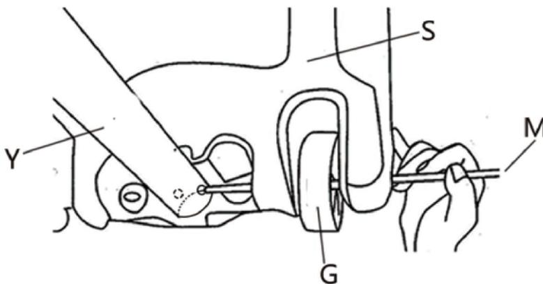
Setzen Sie die Radwelle (M) in das Rad (G), den Sockel (S) und das Ende des unteren Masts (Y) ein, wie gezeigt.
