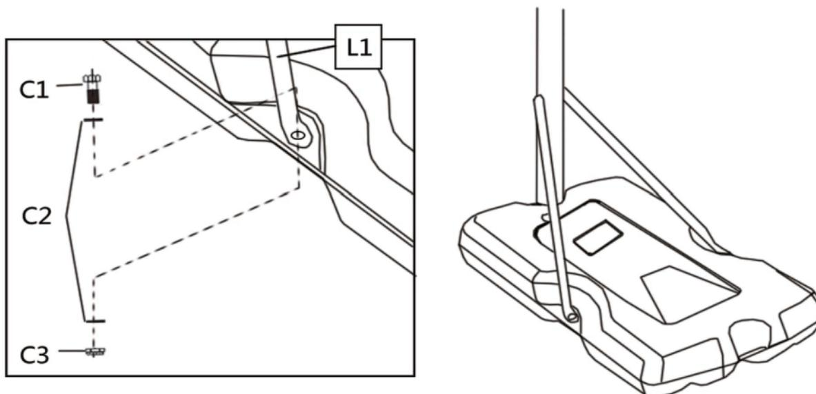
Befestigen Sie das andere Ende der Maststrebe (L1) & (L2) an zwei Seiten des Sockels (S) mit dem Schraubensatz (C1), (C2) & (C3) wie abgebildet.
