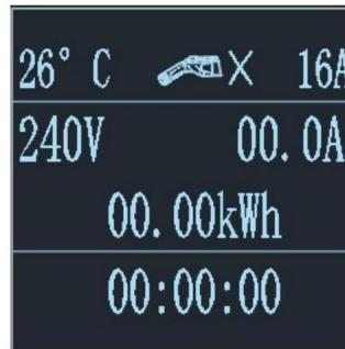
2.1 Régler le courant de charge : cliquer sur le bouton pour ajuster le équipement de charge. Pour EV-B07-EU022B, 32A-24A-20A-16A-32A Cyclez le courant dans cet ordre. Pour EV-B07-EU011B, 16A-13A-10A-8A-16A Cyclez le courant dans cet ordre. Après avoir changé le courant d'utilisation, branchez la tête du pistolet pour charger.
