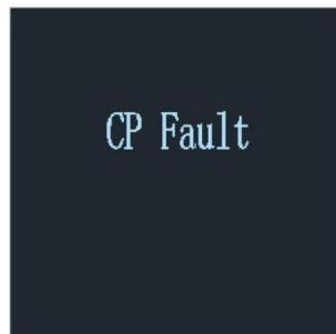
**4.4 Guasto da sovraccorrente:** se la corrente di carica del dispositivo supera la soglia e continua a superare i 5 secondi, il dispositivo interromperà la carica e segnalera un guasto, che non può essere ripristinato automaticamente.
