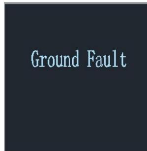
**4.2 Aardfout: De aardingsdraad is niet aangesloten of de aardingsdraad is defect. is slecht. Wanneer dit alarmbericht verschijnt, controleer dan of de aarding is normaal. Nadat u een betrouwbare aarding hebt gecontroleerd, drukt u 5 seconden op de H-knop**
