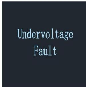
**Obs:** När spänningen detekteras vara under 175V kommer laddningsströmmen att halveras.
