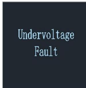
Uwaga: Jeśli napięcie spadnie poniżej 175 V, prąd ładowania zostanie zmniejszony o połowę.
