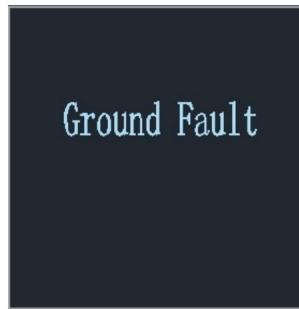
**4.2 Guasto a terra: il filo di terra non è collegato o il filo di terra è scadente. Quando appare questo messaggio di allarme, controllare se la messa a terra è normale. Dopo aver verificato la messa a terra affidabile, premere il pulsante H per 5**
