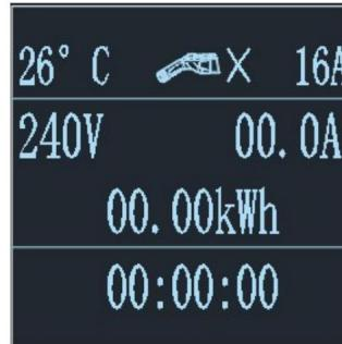
2.1 Pas de laadstroom aan: klik op de knop om de laadapparatuur. Voor EV-B07-EU022B, 32A-24A-20A-16A-32A Laat de stroom in deze volgorde doorlopen. Voor EV-B07-EU011B, 16A-13A-10A-8A-16A Laat de stroom in deze volgorde doorlopen. Sluit na het wisselen van de gebruiksstroom de pistoolkop aan om op te laden.
