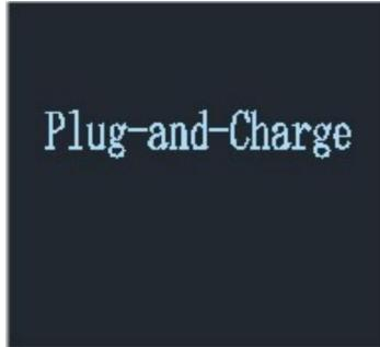
Naciśnij i przytrzymaj ponownie panel ładowania, a na ekranie wyświetli się Plug and Charge, aby przejść do trybu ładowania Plug and Play. Otwórz Location, Bluetooth i Wifi telefonu komórkowego. Jeśli urządzenie ładowane jest w stanie gotowości, aplikacja automatycznie wyszuka urządzenie ładowane, a nazwa urządzenia zostanie wyświetlona.
