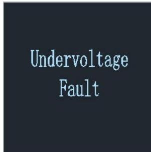
Remarque : lorsque la tension détectée est inférieure à 175 V, le courant de charge sera réduit de moitié.
