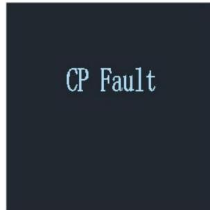
**4.3 Guasto CP:** il dispositivo rileva che la tensione CP supera  $6 \text{ V} \pm 0,8$  o  $9 \text{ V} \pm 0,8$ , segnala un guasto CP, ripristina la tensione entro l'intervallo e risolve il guasto.
