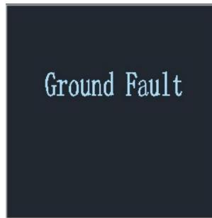
4.2 Défaut de terre : Le fil de terre n'est pas connecté ou le fil de terre est faible. Lorsque ce message d'alarme apparaît, veuillez vérifier si la mise à la terre est normal. Après avoir assuré une mise à la terre fiable, appuyez sur le bouton H pendant 5
