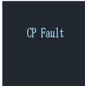
**4.3 CP-storing:** Het apparaat detecteert dat de CP-spanning hoger is dan  $6\text{ V} \pm 0,8$  of  $9\text{ V} \pm 0,8$ , meldt een CP-storing, herstelt de spanning tot binnen het bereik en herstelt de storing.
