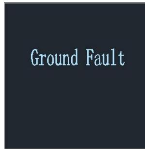
4.2 Falla a tierra: El cable de tierra no está conectado o el cable de tierra es deficiente. Cuando aparezca este mensaje de alarma, verifique si la conexión a tierra es normal. Después de asegurarse de que la conexión a tierra sea confiable, presione el botón H durante 5 segundos.
