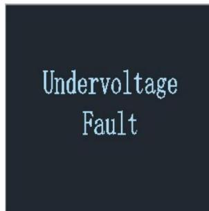
**Hinweis:** Wenn eine Spannung unter 175 V erkannt wird, wird der Ladestrom um die Hälfte reduziert.
