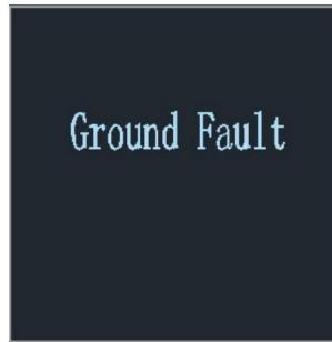
**4.2 Erdschluss: Der Erdungsleiter ist nicht angeschlossen oder der Erdungsleiter ist schlecht. Wenn diese Alarmsmeldung erscheint, überprüfen Sie bitte, ob die Erdung ist normal. Nachdem Sie eine zuverlässige Erdung sichergestellt haben, drücken Sie die H-Taste für 5**
