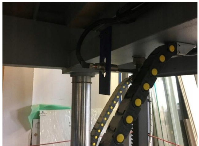
Widok siłowników, systemu prowadzenia oraz systemu kontroli rozłożenia materiału (sensor w prawym-górnym rogu)
