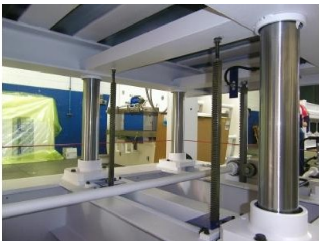
Widok siłowników, systemu prowadzenia oraz systemu kontroli rozłożenia materiału (sensor w prawym-górnym rogu)
