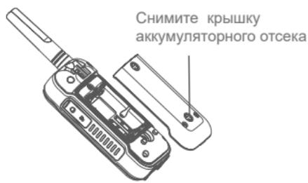
3. Закройте аккумулятор и затяните два винта по часовой стрелке.
