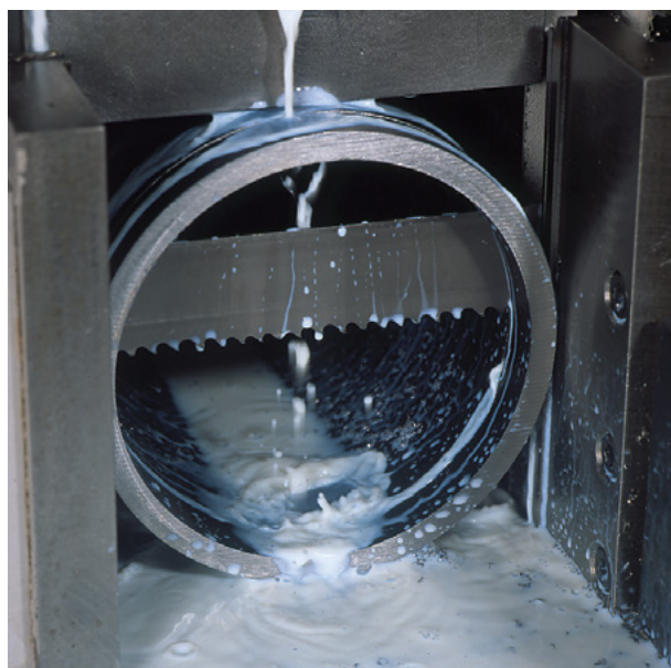
Podczas docierania brzeszczotu należy rozpocząć cięcie materiału ze zmniejszonym posuwem.
