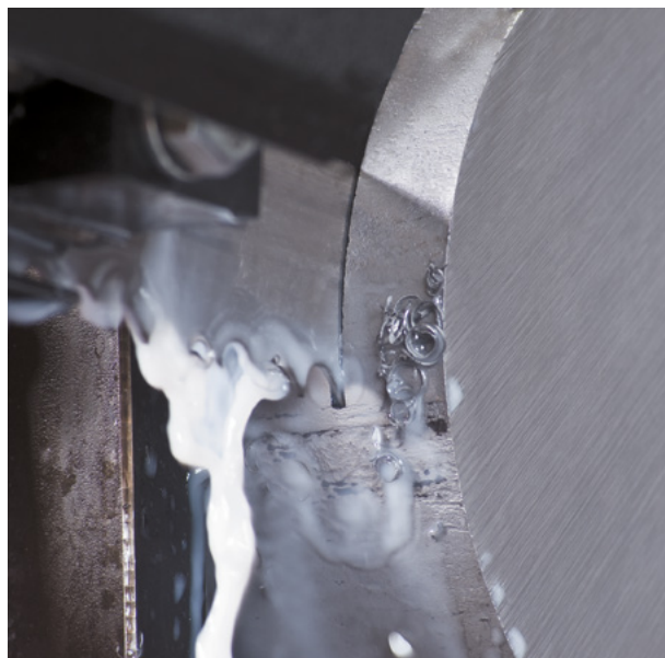
Po zakończeniu procedury docierania, po całkowitym zagłębieniu brzeszczotu w obrabiany detal, należy zwiększać posuw w kolejnych seriach cięć, aż do osiągnięcia zalecanej wydajności cięcia.
