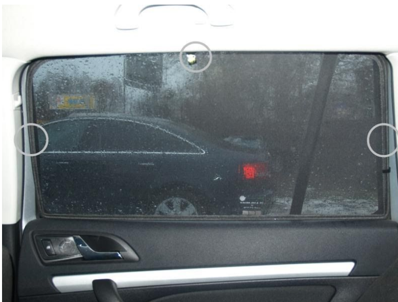
Rys.1 - Miejsca założenia blaszek na drzwiach
