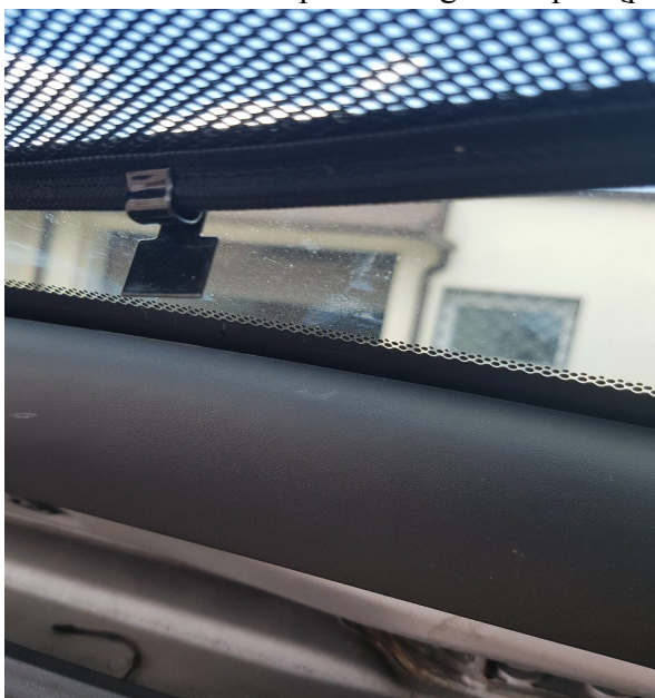
Rys.10 - sposób zamocowania zaczepu w klapie bagażnika
