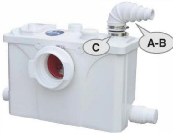
(5-3) Achten Sie außerdem darauf, an der Ecke der PVC-Wasserleitung einen großen Bogen zu verwenden, der aus zwei 45-Grad-Bögen besteht, und keinen rechtwinkligen Bogen; Andernfalls wird die vertikale Hubhöhe beeinträchtigt.
