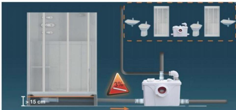
(6-3), Se è necessario collegare più apparecchiature e utilizzare l'ingresso dell'acqua superiore, aprirlo con una sega e collegarlo con un tubo.
