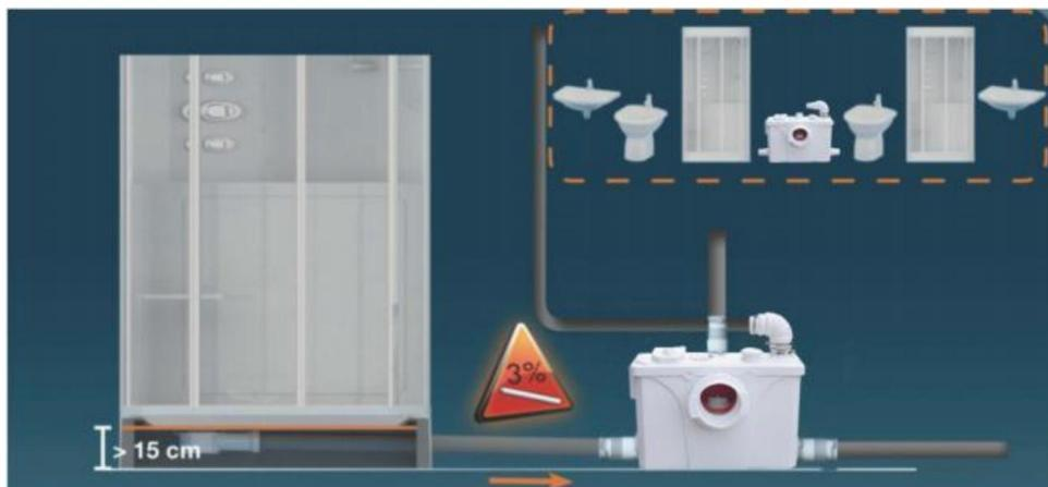
(6-3), Om du behöver ansluta mer utrustning och använda det övre vatteninloppet, öppna det med en såg och anslut det med en slang.
