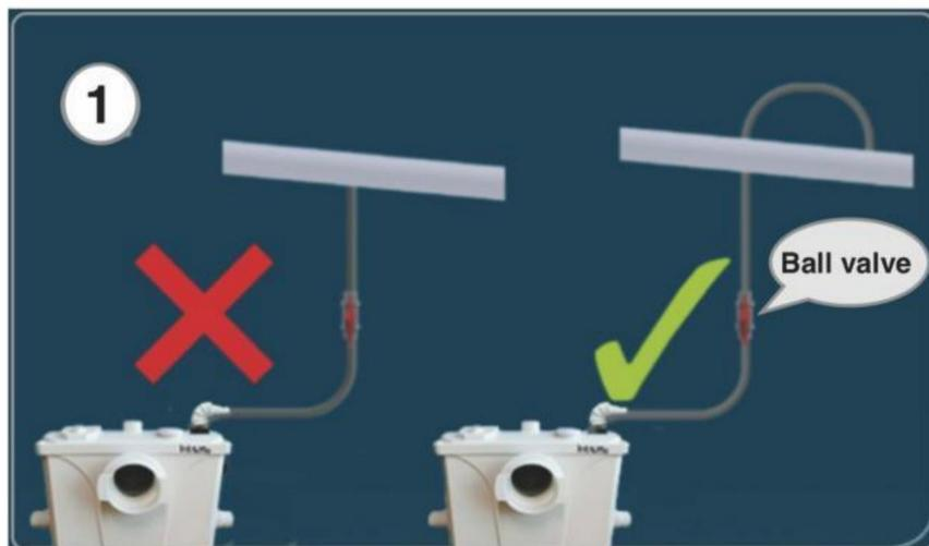
(5-6), Aby uzyskać najlepszą wydajność, należy najpierw spuścić wodę do góry, a następnie spuścić wodę rurą spustową do rury głównej pod kątem 2%-3%: w przeciwnym razie ścieki tak się stanie płynąć z powrotem.
