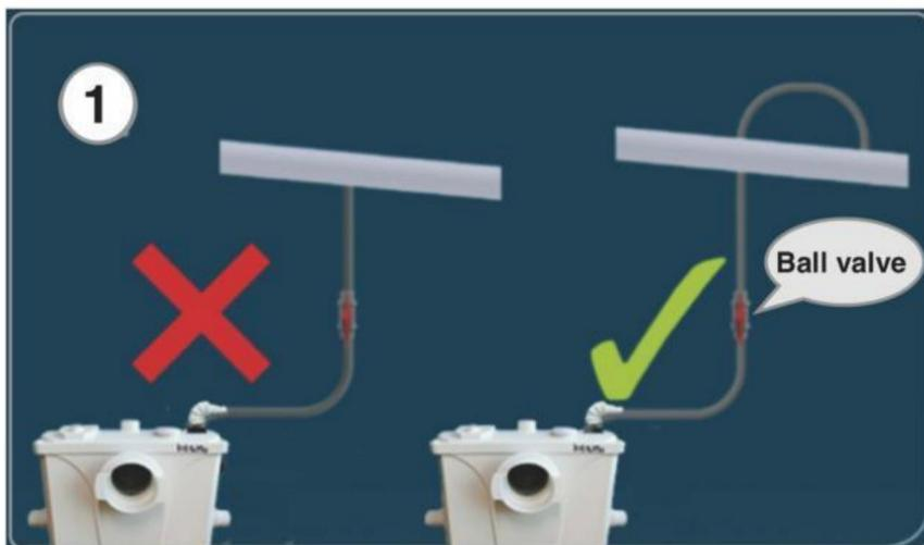
(5-6), Per prestazioni ottimali, scaricare prima verso l'alto e poi scaricare il tubo di scarico al tubo principale con una pendenza del 2%-3%: in caso contrario, il liquame verrà scaricato rifluire.
