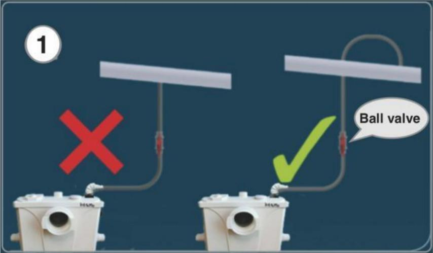
(5-6), para obtener el mejor rendimiento, drene primero hacia arriba y luego drene el tubería de drenaje a la tubería principal con una inclinación del 2% al 3%: de lo contrario, las aguas residuales fluir de nuevo.
