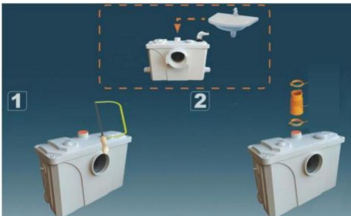
(6-4), Als het toilet niet is aangesloten, kunt u het deksel (J) gebruiken om de toiletwaterinlaat te blokkeren en vervolgens de klem (G) gebruiken om het toilet te bevestigen. Sluit dan alleen de wastafel, doucheruimte en wasmachine aan.
