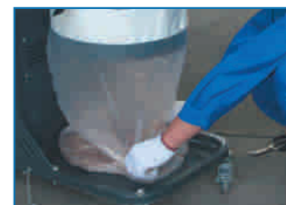
Pojemnik na pył, szybkie i łatwe usuwanie zapełnionego pojemnika
