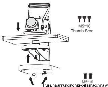
4. Installare la piastra inferiore E stringere IL noccioline di mano
