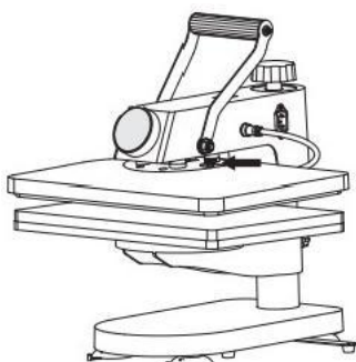
5.Installer le supérieur plaque et serrer les noix par main
