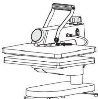
5. Zainstaluj the górny płytą i dokręcać orzechy przez ręką
