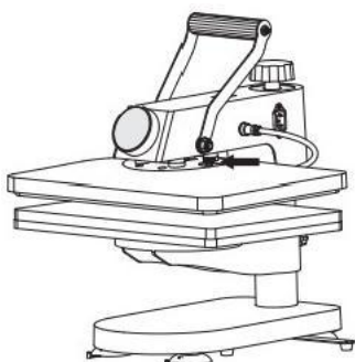
5.Instalar el superior lámina y apretar las nueces por mano
