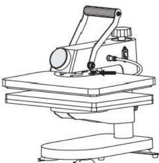
5. Installeren de bovenste bord En vastdraaien de noten door hand
