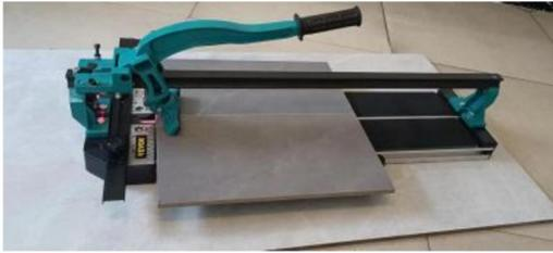
Après avoir marqué et sans déplacer la position de la tuile, le disjoncteur se trouve légèrement sur le bord avant de la tuile et en butée avant.
