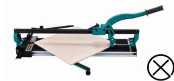
Placez le carreau sur la machine contre la règle d'angle réglée.
