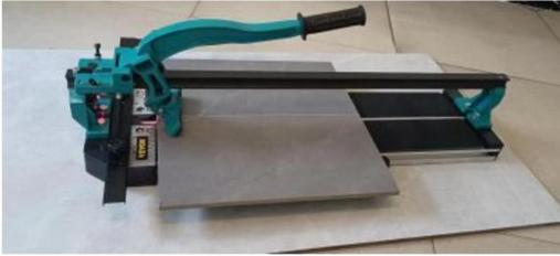
Efter poängsättning och utan att flytta brickpositionen är brytaren något i framkanten av brickan och främre stopp.
