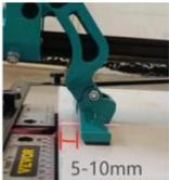
Tips: Efter poängsättning är det bättre att dra tillbaka handtaget för att låta brytaren backa något 5-10 mm. Det är den bästa positionen för att bryta brickan.
