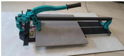
Po nacięciu i bez zmiany położenia płytki, łamacz znajduje się lekko na przedniej krawędzi płytki i zatrzymuje się z przodu.
