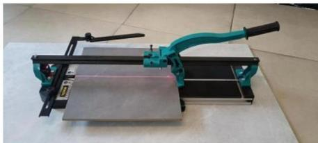
Coloque la rueda de corte en el borde trasero de la baldosa.
