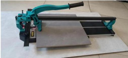
Después de marcar y sin mover la posición de la pieza, el interruptor queda ligeramente en el borde delantero de la pieza y tope delantero.
