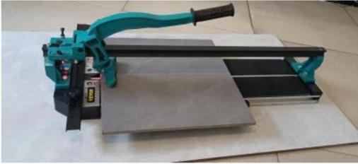
Nach dem Anritzen und ohne die Fliesenposition zu verschieben, liegt der Brecher leicht an der Vorderkante der Fliese und am vorderen Anschlag an.
