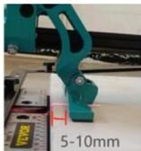
Tips: Na het scoren is het beter om de hendel terug te trekken om de breker 5-10mm terug te laten slaan.
