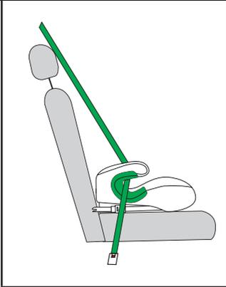
Das Diagramm zeigt einen grauen Autositz im Profil. Ein grüner ISOFIX-Anker ist an der Basis des Sitzes montiert. Ein grüner 3-Punkt-Sicherheitsgurt verläuft über die Schulter und den Rücken des Kindes, ist an der Hüfte geschnallt und verläuft nach unten zum Boden. Ein grüner ISOFIX-Adapter ist an der Basis des Autositzes befestigt, der mit dem grünen ISOFIX-Anker des Fahrzeuges verbunden ist. | ISOFIX + 3-Punkt-Gurte |
