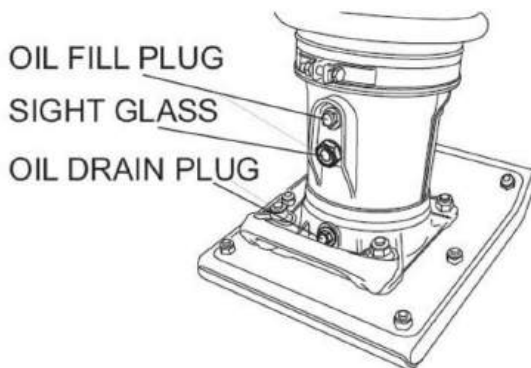
Abbildung 14 Ablassschraube des Fußgehäuses
