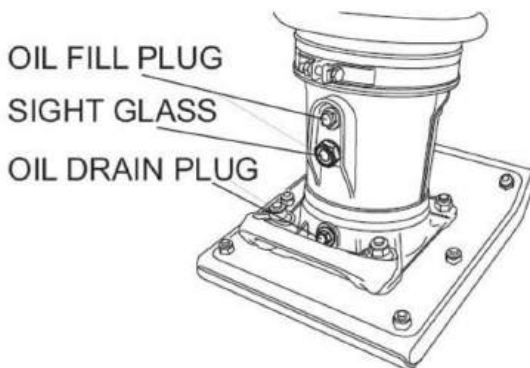
Figuur 14 Aftapplug voetbehuizing
