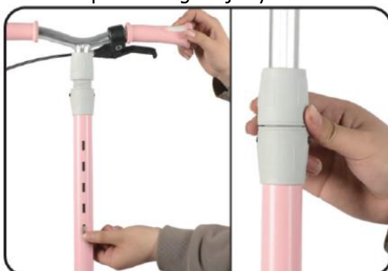
5. Wybierz odpowiednią wysokość i zaciśnij zacisk.
