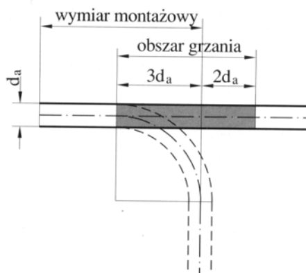
Rys. 10. Wyznaczanie przebiegu osi giętej rury [4]
