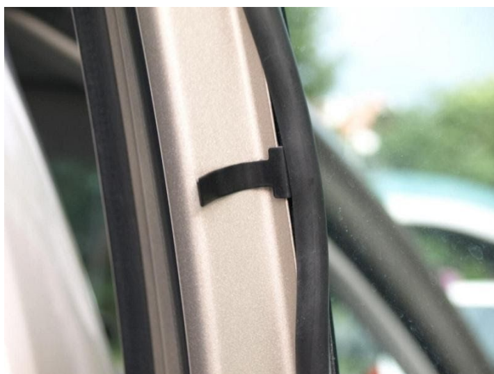
Rys.2 - Sposób montażu uchwytów
