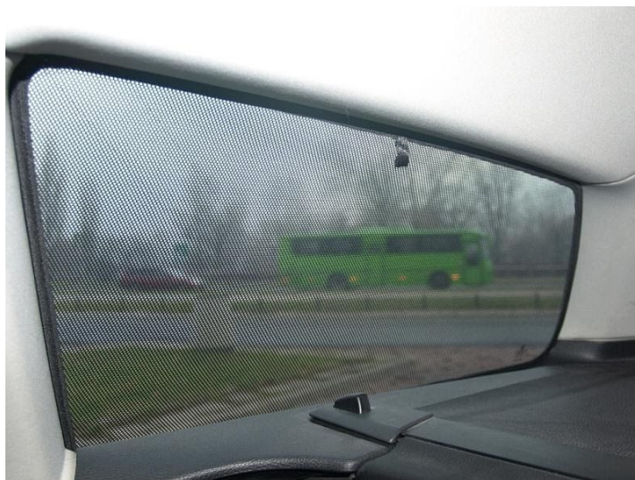
Rys.4 - Mocowanie zasłonki w przestrzeni bagażowej
