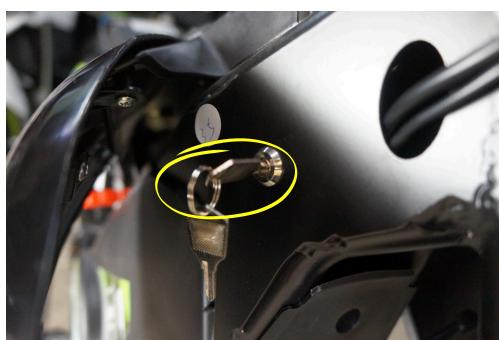
Po ustawieniu włącznika z pozycji 0 do pozycji 1, usiądź na siedzeniu, jedną stopę ustaw na podnóżku/stopce, drugą asekuruj pionową pozycję względem podłoża.
