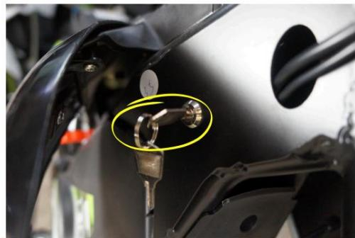
Po otočení spínače z polohy 0 do polohy 1 se posaděte na sedadlo s jednou nohou na místě na stupačku/nohu, druhým zajistěte svislou polohu vůči zemi.
