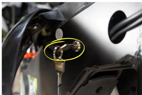
Po otočení spínača z polohy 0 do polohy 1 si sadnite na sedadlo s jednou nohou na mieste na opierku nôh/nohu, druhou zaistite vertikálnu polohu voči zemi.
