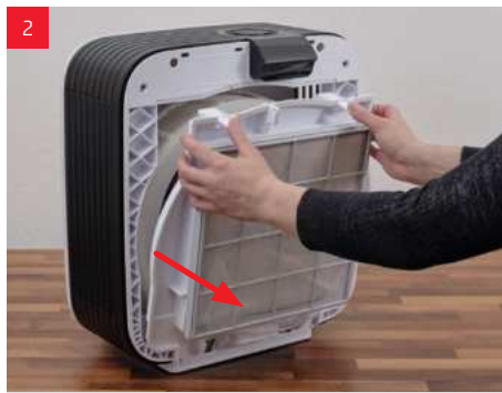
Rimuovere il portafiltro unitamente ai filtri.
