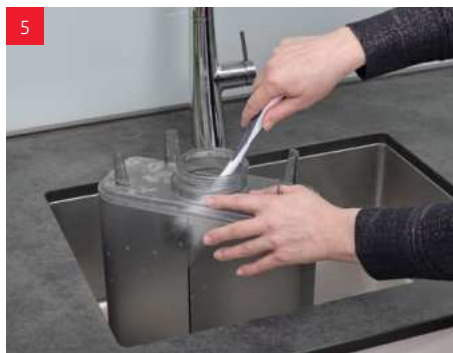
5 Rengjør vanntanken og vannskålen.
