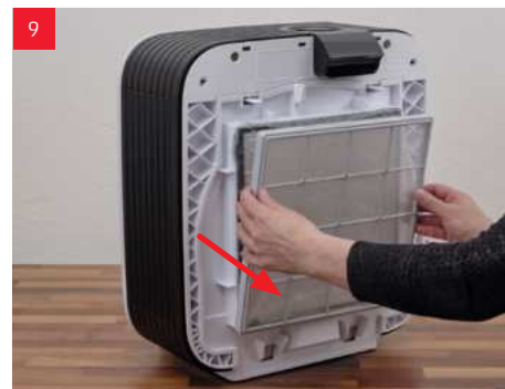
Verwijder het voorfilter.
