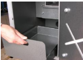
Fot.1. Usuwanie popiołu za pomocą szuflady popielnika.
