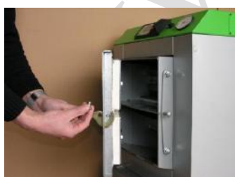
Fot.10. Po odwróceniu zamontować uchwyt zaciskowy.
