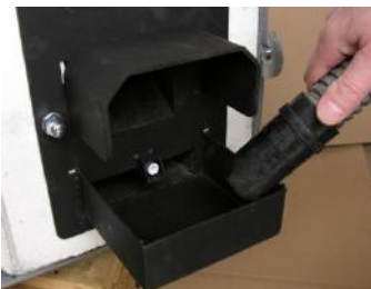
Fot.4. Czyszczenie komory powietrznej palnika QPel
