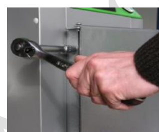
Fot.8. Przykręcić śruby montażowe zawiasów
