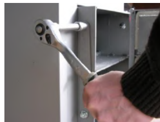
Fot.3. Odkręcić rygiel zamka
