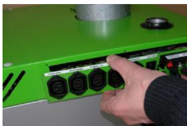
Fot.1. Odkręcić przyłącze zasilająco-czujnikowe
