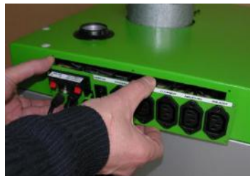
Fot.2. Przykręcić po drugiej stronie obudowy górnej
