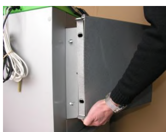
Fot.7. Odwrócić drzwiczki i zamontować do włazu po drugiej stronie.
