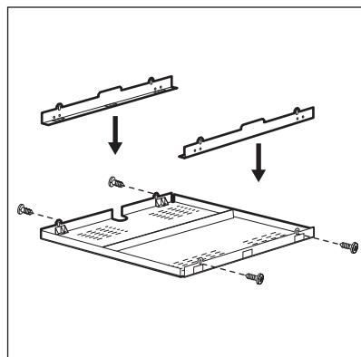
Po zamontowaniu kasety ochronnej (wyposażenie dodatkowe) nie ma konieczności montażu przegrody zabezpieczającej bezpośrednio pod płytą grzejną. Wyposażenie dodatkowe w postaci kasety ochronnej może być niedostępne w niektórych krajach. W celu uzyskania dodatkowych informacji należy skontaktować się z miejscowym dostawcą.
