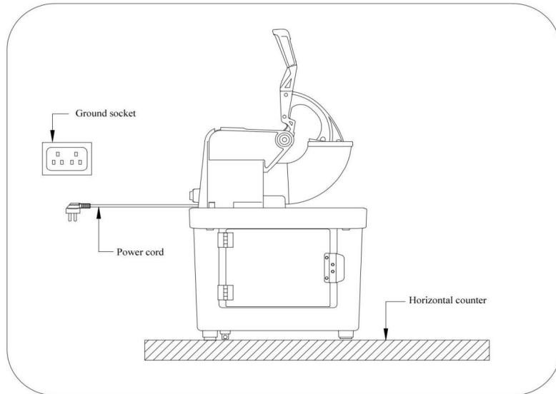
2. Trova un luogo piano per l'elettrodomestico dove sia protetto dalla luce solare diretta e altre fonti di calore (ad esempio, stufa, forno, radiatore). Posizionare l'apparecchio su un'superficie piana. Assicurarsi che ci siano almeno 15 cm di spazio tra la parte posteriore e i lati dell'apparecchio e il muro. Non appoggiare nulla sull'apparecchio.
