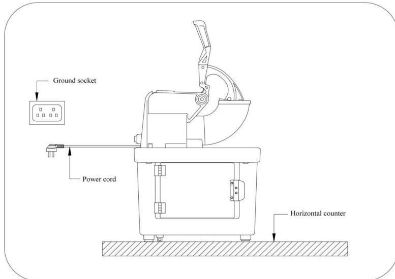
2. Hitta en plan plats för apparaten där den är skyddad från direkt solljus och andra värmekällor (dvs spis, ugn, radiator). Placera apparaten på en plan yta. Se till att det är minst 15 cm utrymme mellan baksidan och sidorna av enheten apparaten och väggen. Placera inget på apparaten.
