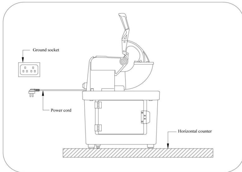
2. Znajdź płaskie miejsce dla urządzenia, w którym będzie chronione przed bezpośrednim działaniem promieni słonecznych. i inne źródła ciepła (tj. piec, piecyk, kaloryfer). Umieść urządzenie na płaska powierzchnia. Zapewnij co najmniej 15 cm przestrzeni między tyłem a bokami urządzenia i ściany. Nie kładź niczego na urządzeniu.
