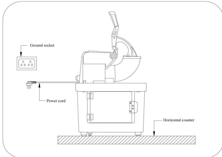
2. Trouvez un emplacement plat pour l'appareil, à l'abri de la lumière directe du soleil et d'autres sources de chaleur (c.-à-d. cuisinière, four, radiateur). Placez l'appareil sur une surface plane. Assurez-vous d'avoir au moins 15 cm d'espace entre l'arrière et les côtés de la l'appareil et le mur. Ne rien poser sur l'appareil.
