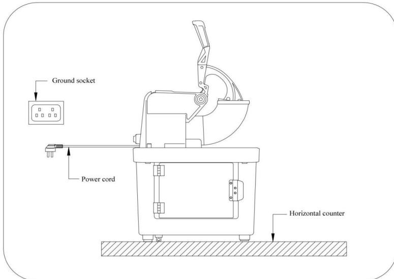
2. Zoek een vlakke plek voor het apparaat, waar het beschermd is tegen direct zonlicht en andere warmtebronnen (bijv. fornuis, oven, radiator). Plaats het apparaat op een vlakke ondergrond. Zorg voor minimaal 15 cm ruimte tussen de achterkant en de zijkanten van de apparaat en de muur. Plaats niets op het apparaat.
