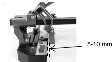
Tips: Efter poängsättning är det bättre att dra tillbaka handtaget för att låta brytaren gå något tillbaka 5-10 mm, det är den bästa positionen för att bryta brickan.
