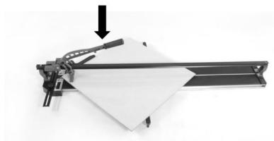
Après avoir marqué et sans déplacer la position de la tuile, le disjoncteur est légèrement en avant bord de la tuile et butée avant.
