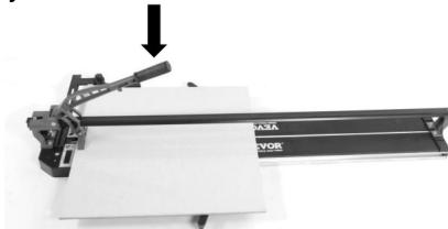
Efter poängsättning och utan att flytta brickpositionen är brytaren något i fronten kakelkant och främre anslag.
