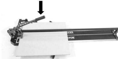
Après avoir marqué et sans déplacer la position de la tuile, le disjoncteur est légèrement en avant bord de la tuile et butée avant.
