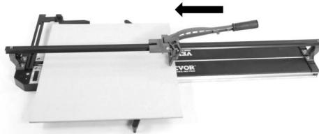
Setzen Sie das Schneidrad an der hinteren Kante der Fliese an.
