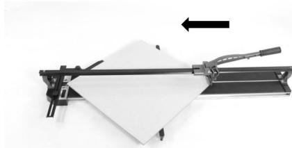
Położ płytkę na maszynie, przystawiając ją do ustawionego kątomierza.
