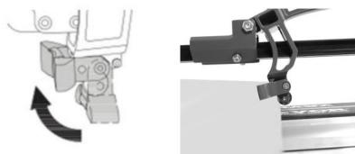
Schieben Sie das Rad nach vorne, indem Sie den Griff mit mittlerem Druck nach unten drücken.
