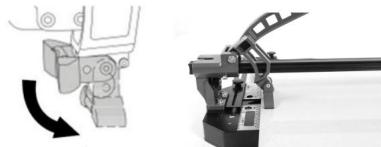
Den Griff etwas anheben und den Brecher loslassen, so dass der Brecher flach auf dem Fliese.
