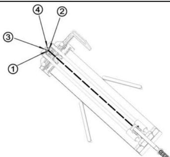
4, Lorsque l'irradiation laser est trop loin/haut, ajustez les numéros 3 et 4 vis dans le sens des aiguilles d'une montre.
