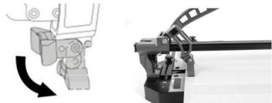
Lyft handtaget lite och släpp brytaren så att brytaren är platt på bricka.
