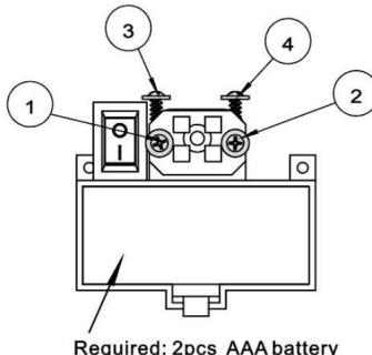
1, Hay cuatro tornillos para el dispositivo láser.
