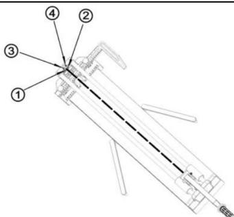
4. Cuando la irradiación láser es demasiado lejos/alto, ajuste los n.º 3 y 4 tornillos en el sentido de las agujas del reloj.
