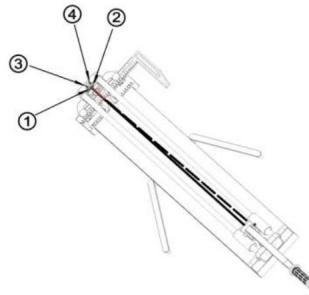
2. Als de laser naar links is gericht, stel dan schroef nr. 2 met de klok mee of Draai de schroef nr. 1 tegen de klok in.
