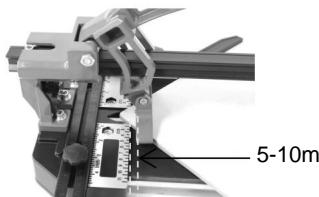
Tips: Efter poängsättning är det bättre att dra tillbaka handtaget för att släppa brytaren något backtrack 5-10mm, det är den bästa positionen för att bryta plattan.
