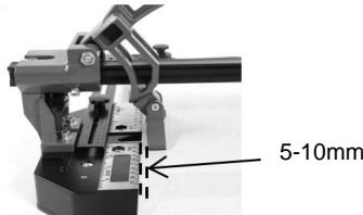
Tips: Nadat u de tegel hebt gebroken, kunt u het beste de hendel terugtrekken, zodat de breker 5-10 mm terug kan slaan. Dit is de beste positie om de tegel te breken.
