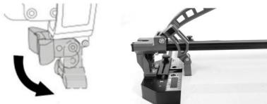
Til de hendel een beetje op en laat de schakelaar los, zodat de schakelaar plat op de tegel.
