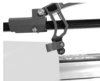
Stellen Sie sicher, dass sich der Unterbrecher nach oben zum Magneten auf der Gleitstange befindet.
