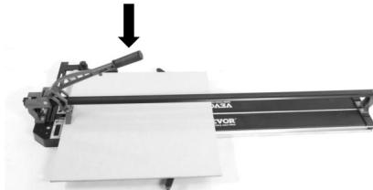
Después de marcar y sin mover la posición de la ficha, el rompedor está ligeramente al frente del borde de la baldosa y tope frontal.
