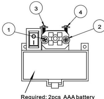
1, Det finns fyra skruvar för laseranordning.
