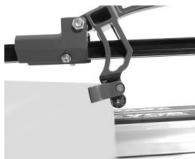
Upewnij się, że wyłącznik jest skierowany ku górze, w kierunku magnesu na pręcie przesuwnym.
