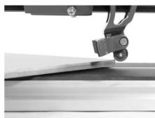
Umieść kółko tnące na tylnej krawędzi płytki.
