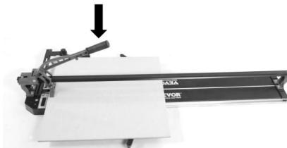
Po nacięciu i bez przesuwania położenia kafelka, łamacz jest lekko na przodzie krawędź płytki i ogranicznik przedni.
