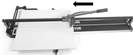
Coloque la rueda de corte en el borde trasero de la baldosa.
