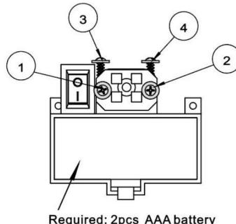
1. Ci sono quattro viti per il dispositivo laser.
