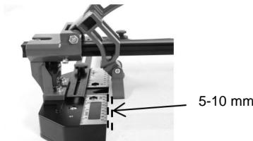
Tipps: Nach dem Ritzen ist es besser, den Griff zurückzuziehen, damit der Brecher 5–10 mm leicht zurückgehen kann. Dies ist die beste Position zum Brechen der Fliese.
