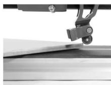
Setzen Sie das Schneidrad an der hinteren Kante der Fliese an.
