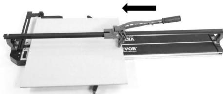
Umieść kółko tnące na tylnej krawędzi płytki.
