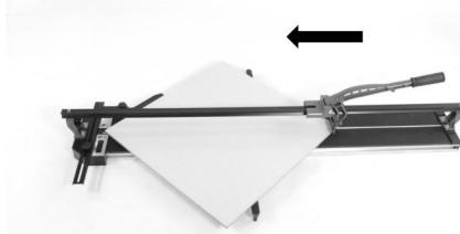
Placez le carreau sur la machine contre la règle d'angle réglée.
