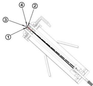
2. Si el láser está sesgado hacia la izquierda, ajuste el tornillo n.º 2 en el sentido de las agujas del reloj o el tornillo n.º 1 en sentido antihorario.
