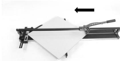
Leg de tegel op de machine tegen de ingestelde hoekliniaal.
