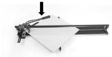
Nach dem Einritzen und ohne die Fliesenposition zu verschieben, liegt der Brecher leicht vorne Fliesenkante und Frontanschlag.
