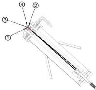
2. Si le laser est orienté vers la gauche, réglez la vis n° 2 dans le sens des aiguilles d'une montre ou la vis n°1 dans le sens inverse des aiguilles d'une montre.
