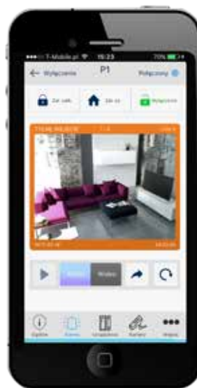
Funkcja wideoweryfikacji. Wyświetlanie zdjęć wysyłanych z czujek z kamerami
